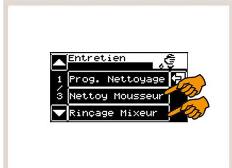
Le nettoyage du mousseur et le rinçage du mélangeur peuvent être effectués séparément.
