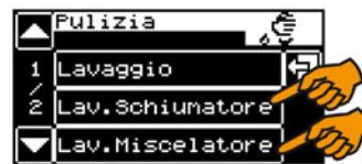
Pulizia dello schiumatore e lavaggio del miscelatore possono essere eseguiti separatamente.
