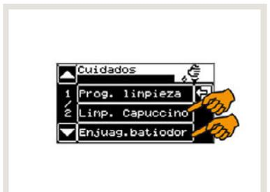
*El espumador y el mezclador se pueden limpiar por separado.*
