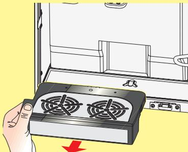
Retirer le bac d'égouttage. Retirer le couvercle et vider le bac d'égouttage. Nettoyer le capteur sur le couvercle.
