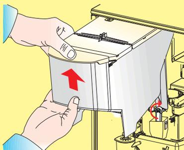
Fermez la buse de sortie de la cartouche de café en la faisant pivoter horizontalement. Extraire le réservoir à café.
