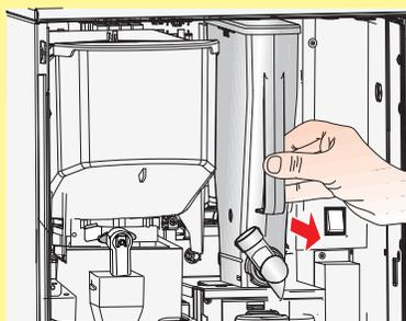
Fermer les tuyaux de sortie des bidons de produit instantané en poussant les tuyaux vers le haut. Sortir les bidons.
