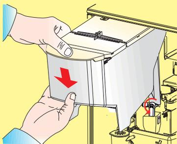
Rouvrir le réservoir à grains de café en tirant sur la plaque verte. Faites pivoter la buse en position verticale
