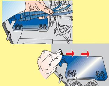
Retirer le support des buses. Dévisser la molette du côté gauche de l'armoire.
