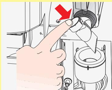
Ouvrir les tuyaux de sortie en poussant les tuyaux vers le bas.
