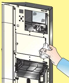
Nettoyer la porte à l'intérieur et à l'extérieur avec un chiffon propre et humide.
